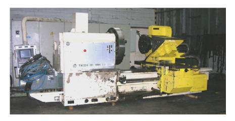
DIAMETRO TORNIBILE SUL BANCO: 1350 mm DIAMETRO TORNIBILE SUL CARRO: 950 mm LUNGHEZZA MAX TORNIBILE: 1000 mm
